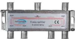
Repartidor de seis saídas, frequência 5-2400 MHz com passagem de corrente. Conector de ficha F.
